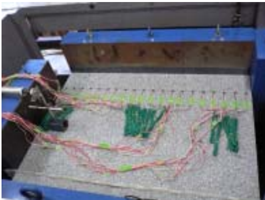
図 3．大型剪断実験装置の岩石試料部分の拡大図．岩石試料は三つのブロックからなり，画面上で横方向に二つの接触面が存在する．そのうち，奥の面は，岩石どうしの接触面であり固着滑りを発生させる．この面の周辺に 20 チャンネルの歪み計を設置して，固着滑りの繰り返しに伴う歪みの時系列記録を取得した．手前側の面は剪断強度の低いテフロンシートを挟むことで，固着滑りを発生させ
