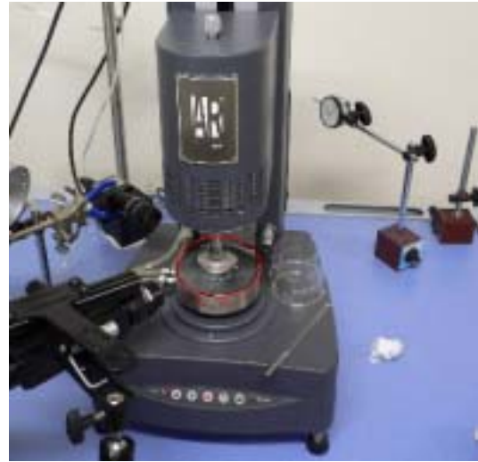
図 4．回転剪断実験装置の全景．画面中央部の赤丸で示した回転円盤とその下部に固定した試料とを接触させ，円盤上部に伸びる軸に上方から回転運動を加えることで試料に力が加わる．この力が試料の剪断強度を超えると滑りが生じるが，一定速度での載荷を続けることで固着滑りの繰り返しが観察される．
