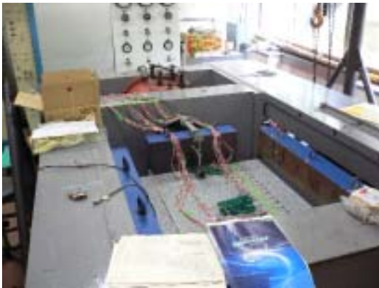
図 2．大型剪断実験装置の全景．画面奥の油圧ピストンから画面手前の岩石試料に載荷される．
