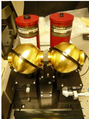
図2 開発した双積分球光学系
