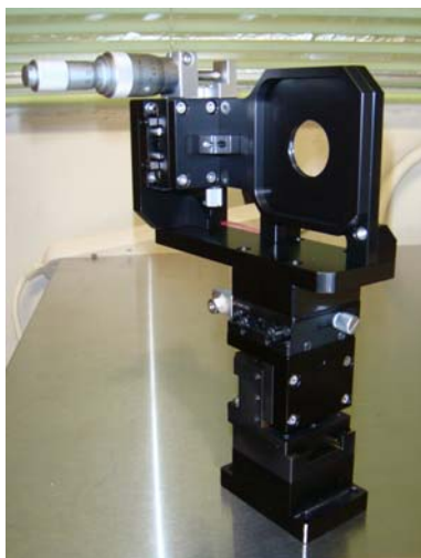
図3 試料厚み可変サンプルホルダー
