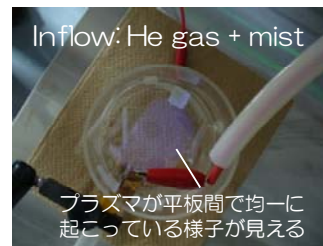
図2. ミストを導入したときの大気圧プラズマ放電の様子
