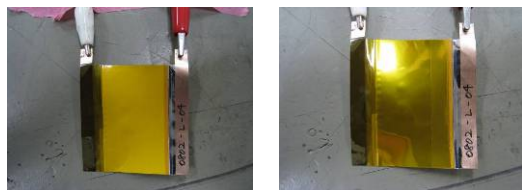
図 2 開発した姿勢制御デバイス (左: OFF (拡散反射), 右: ON (鏡面反射))
