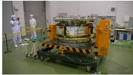
図4 ソーラー電力セイル実証機イカロス(直径1.6m, 高さ約80cmの円筒形の探査機)
