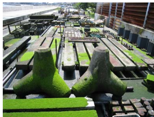
図-1 試験体の海洋環境暴露状況
