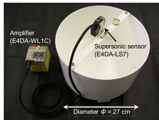
図1 新規作成した超音波式小型パン蒸発計。
