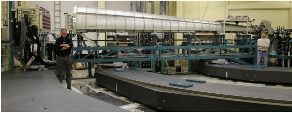
図 1. 理研ビームラインBL42LXU設置のX線非弾性散乱測定装置
