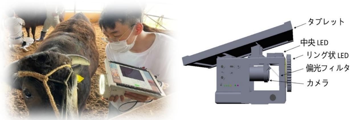
図 1 左 ハンディカメラで撮影；右 カメラ構造
