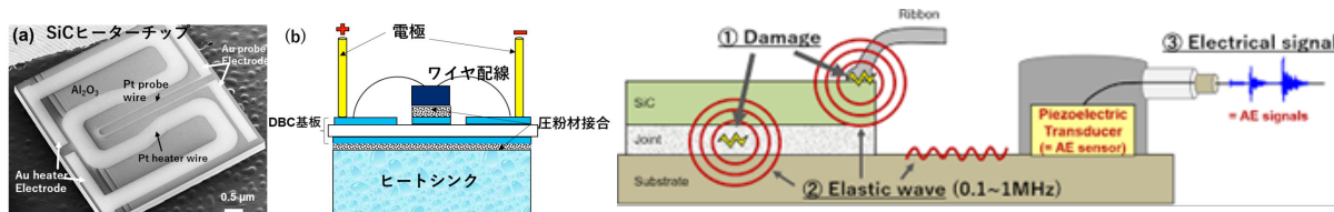
(図 3) パワーデバイス実験用ヒーターチップと AE センシングによるデータ収集システム
