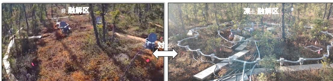
図2. 本研究で開発した土壌昇温・凍土融解の野外実験装置の様子。直径6mの外周に1.5mのヒーターを埋設し、その内部を徐々に温暖化させるシステムである。
