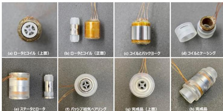
図3 試作した超小型水力発電機
