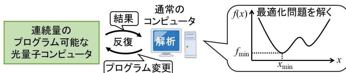
図1: 連続量の量子近似最適化アルゴリズムの概要
