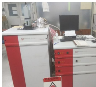
図2：富山大学機器分析施設の磁気特性精密測定システム
