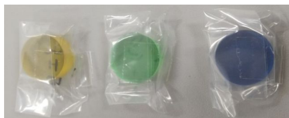
図4：不純物をドーブしたサファイアサンプル（直径20mm、厚さ9mm）。緑と青の不純物は同じである。
