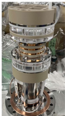
図 3: 本研究で開発した密閉型石英容器。
