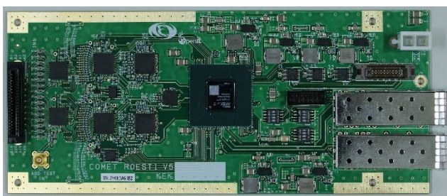
図1 メイン検出器(ストロー検出器)の信号処理システム完成版
