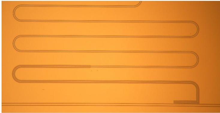
図 3 試作したハイブリッド構造を持つ超伝導共振器
