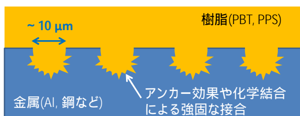
図1 微細構造を利用した金属樹脂成形接合
