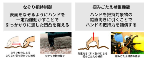
図2：把持力補償機能の概要
