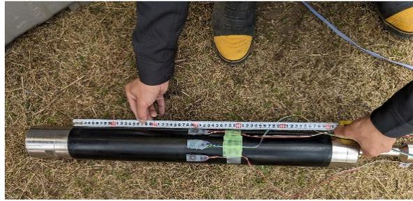
4) ゾンデ外側に貼り付けた MEMS 水圧センサ
