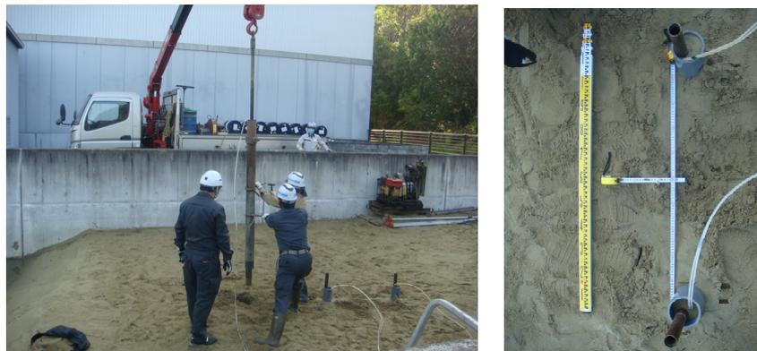
図5 大型模型土槽を用いた試験の概要と実施状況
