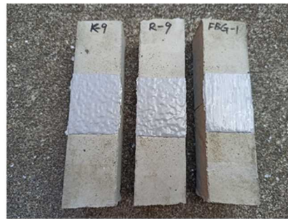
写真 1 アクリルゴム系補修材で塗膜を施した試験体の外観
