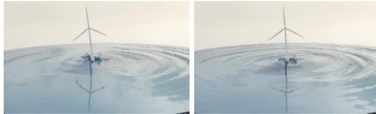
図-7 Draupner Wave と係留式浮体構造物の相互作用（左図： $\theta = 0^\circ$ 、右図： $\theta = 120^\circ$ ）
