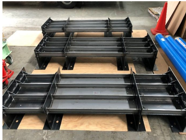
図4 製作した防撓構造試験体
