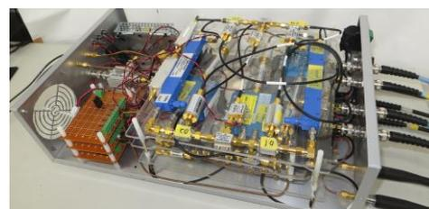
図 4 開発した直交検波パルスドップラレーダ
