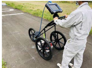
(a) 室内モデル実験@ 2100 MHz (b) 実際の道路での実験@ 900 MHz
