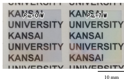
図 1 スパッタリング法で作製した \text{TiO}_2 , (\text{Ti}, \text{Nb})\text{O}_2 膜の外観
