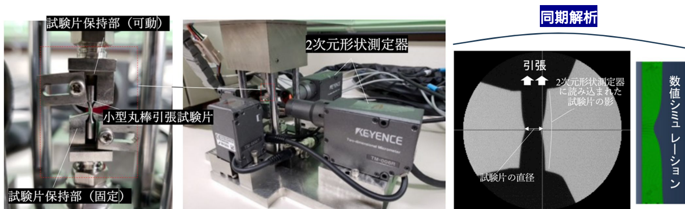
図 1 開発した小型引張試験システム。切り欠き部の変形抵抗測定を実現。
