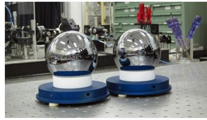
図3  $^{28}\text{Si}$  単結晶球体
