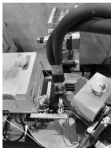
図3. 中性子小角散乱とATR-FTIRの同時測定系の試料位置の様子
