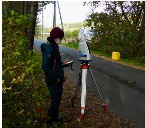
図2 地上設置型LiDARスキャナによる計測
