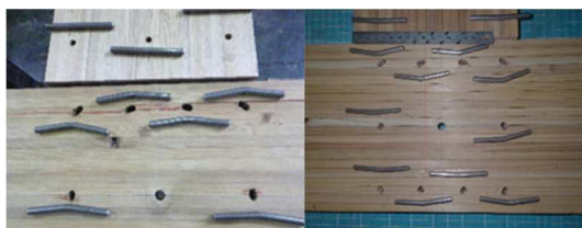
写真 3 DP 試験体の破壊性状 (左: 実大 右: 1/3)
