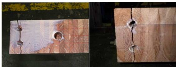
写真 2 GIR 試験体の破壊性状 (左: 実大 右: 1/3)
