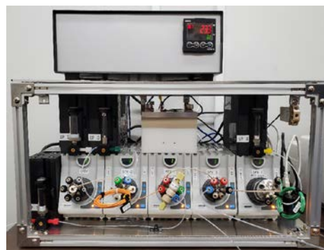
図 7. 一体型マイクロスケール自動濃縮合成装置とインターフェイス(上)
