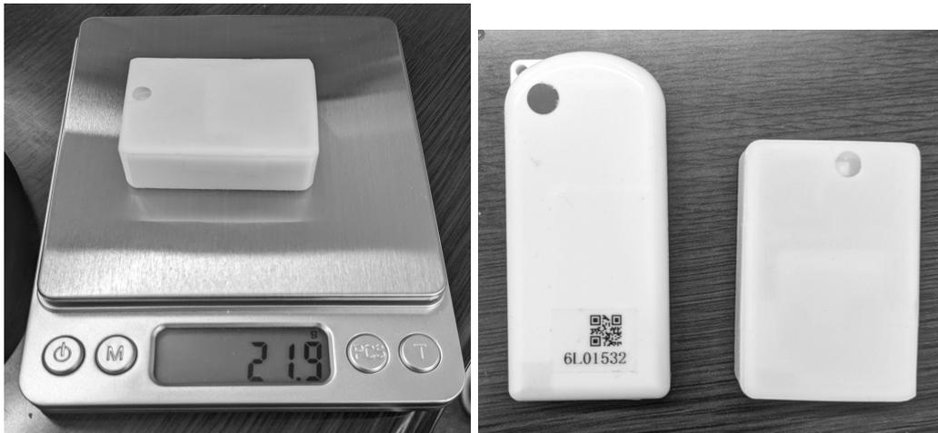
図5 本研究で開発した新型のD-シャトル線量計。旧型のD-シャトル線量計との比較写真(右)
