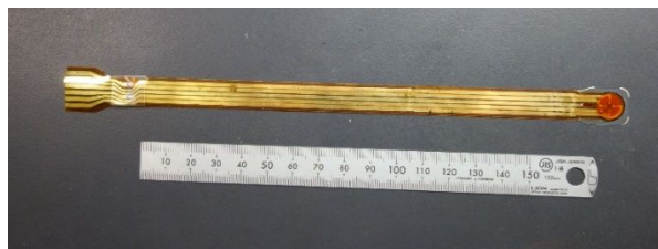
図2 3軸力覚センサ(せん断力センサと圧力センサを積層)
