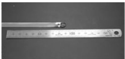
図1 せん断力センサ(2軸)
