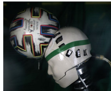
図 2 次世代ダミーによるサッカーボールヘディング実験
