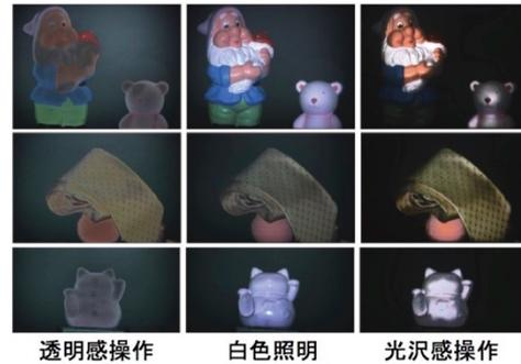
図1 実時間の見かけの操作の例:同軸光学系を用いることで投影の位置合わせやモデルを必要としない光沢感や透明感の実時間操作を実現した。
