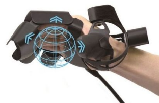
図2 非接地型の触覚提示装置
