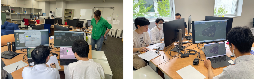
図2 ESCAPE Light シミュレータ：左図の手前は、左からシミュレーション統括卓、パイロット卓。右図手前は、航空路のレーダー管制を模擬した管制卓
