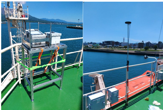
図1. 新青丸に設置した(左)マイクロ波放射計・雲カメラと(右)GNSS 受信アンテナ.
