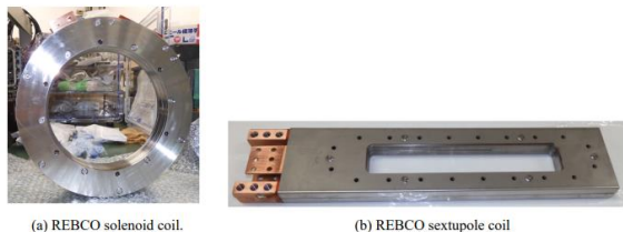
図 1 製作した(a)高温超伝導 REBCO ミラーコイルと(b)レーストラック型六極コイル
