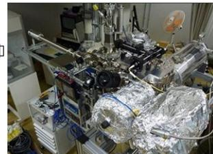
励起光には通常使われる 532nm レーザーを用いる (図 9, 10)。しかしまだ出力試験はできていない。高圧印加試験を前にして 300kV コッククロフトが暴走する事態が発生した。調査の結果は電源自体のトラブルが判明し別の電源とその制御系を用意する必要が生じたからである。
