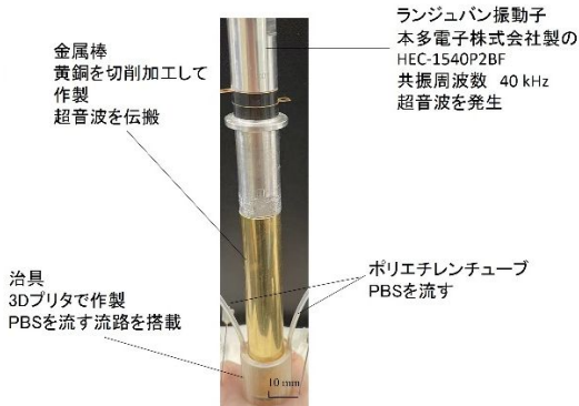
図7 試作した粘膜からの細胞採取用デバイス
