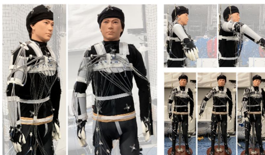
図16: 試作した上半身用表面骨格型機構(左:介護練習用人形に装着した様子、右上:吊り下げ状態での肩水平内転、右下:初期(左)・肩外転(中)・複合動作(右))
