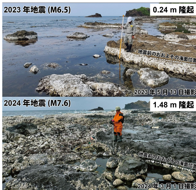
図2 能登半島北東部堂ヶ島東における2023年および2024年能登半島地震に伴う隆起で変化した海岸の様子。 宍倉ほか(2024)に基づく。
