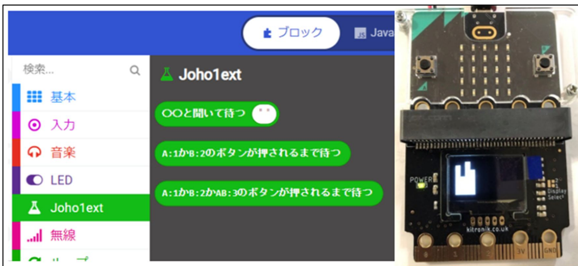
図1. 情報 の授業で利用した入力拡張ブロックとOLED液晶を用いた棒グラフの表示
