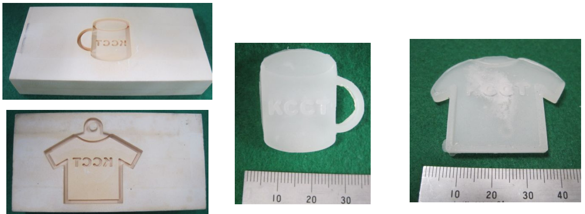
図6 製作した簡易型と射出成形品例（2023年度）
