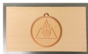
(b)CNC加工による簡易型
