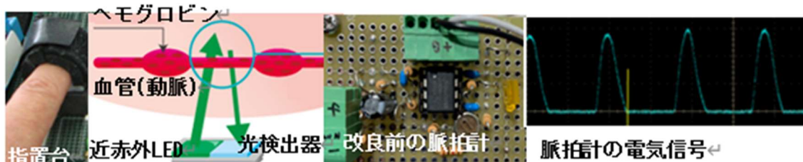
図3 医療機器を模倣した光を利用した脈拍計を使った教育システム(改良前)
