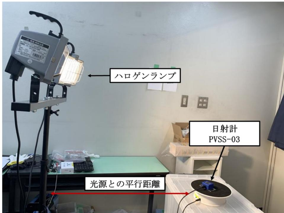
図3 光照射システムによる実験の様子
