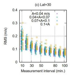
緯度 30 度におけるシミュレーションの結果を一例として示す。A は与えた近慣性周期内部波の振幅。それに対する平均自乗誤差を縦軸にある深さにおける LADCP 下降時と上昇時の時刻の差(分)をプロットした。誤差が A と同程度あるいは大きく相対誤差が 100 % を超えていることがわかる。ここで推定した量は三角関数の係数でこれを近慣性内部波の振幅に換算してもやはり相対誤差は 100 % 程度で位相の誤差が 30 度程度となる。
