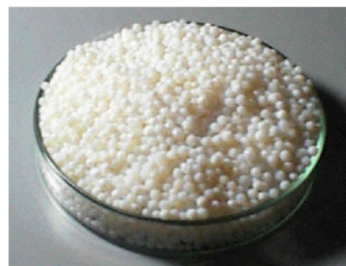
図2 複合型酸化チタンの例 (TiO 2 /SiO 2 )
