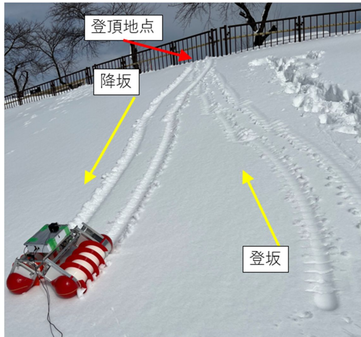
図7 斜面登坂、降坂後の様子
